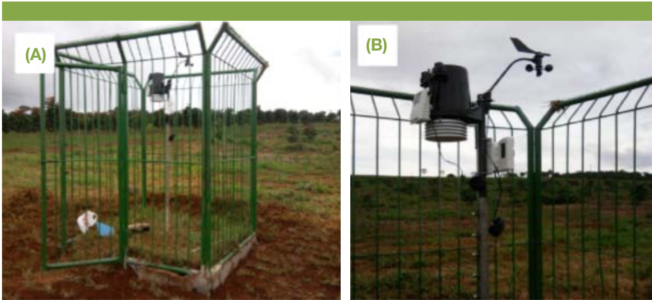
Figura 6. Detalhes da estação meteorológica automatizada Davis Vantage PRO2 (A), com console wireless (B), instalada a 50,00 m da área experimental de Khaya ivorensis , entre 2012 e 2013, em Bonfinópolis, GO.
