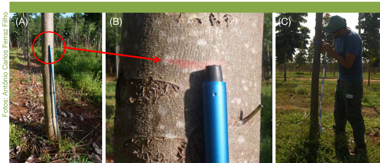
Figura 3. Determinação da altura para medir o diâmetro à altura do peito da árvore utilizando um gabarito com 1,30 m de altura (A), marcação do ponto de medição utilizando giz de cera (B) e medição da circunferência da árvore utilizando fita métrica (C).
