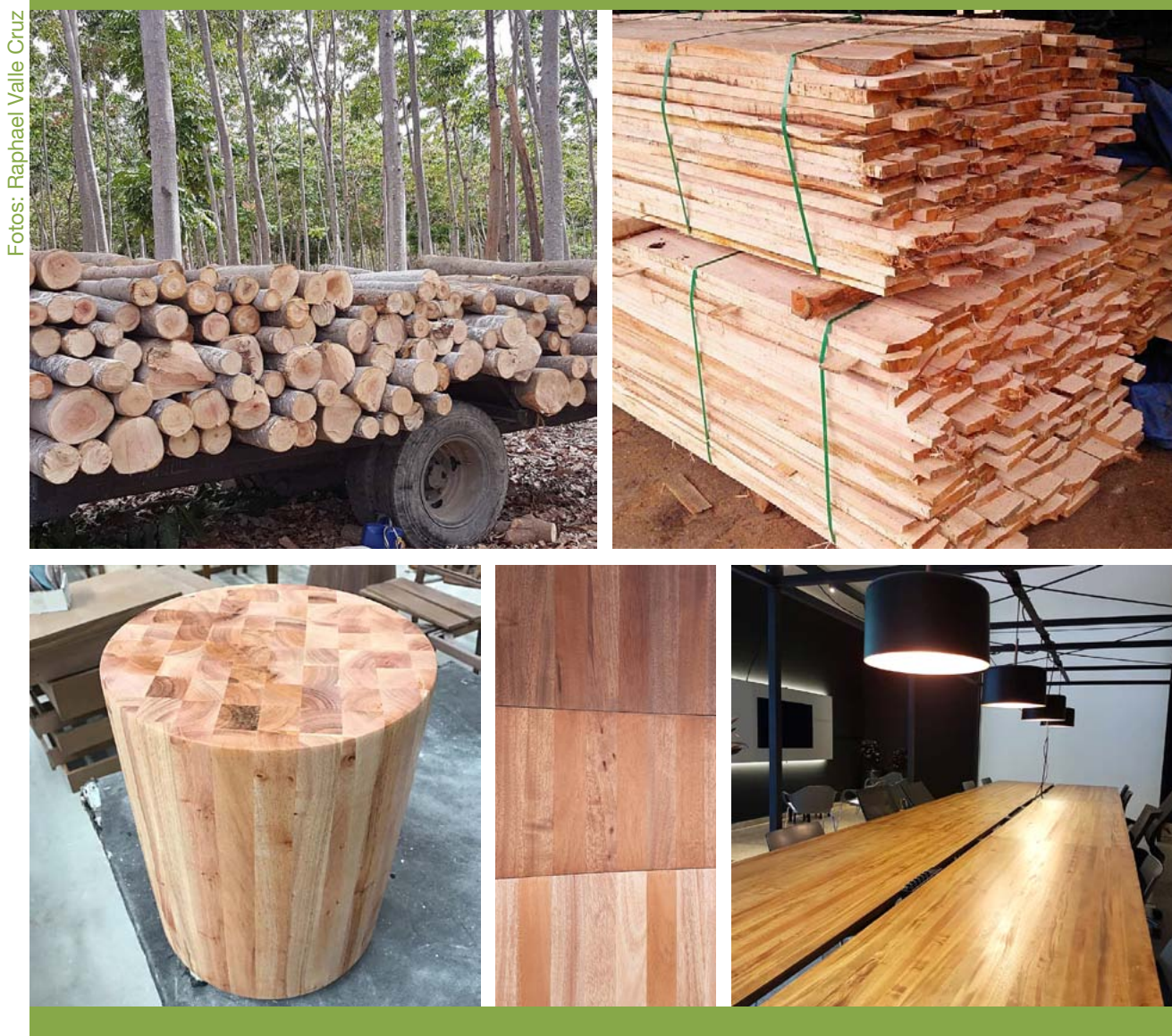
Figura 7. Toras cortadas e serradas de mogno-africano, provenientes de árvores desbastadas aos nove anos de idade, secas em estufa e usadas na produção de bancos, painéis e mesas.
