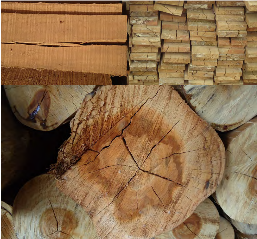
Figura 15. Rachaduras em tábuas e toras de eucalipto provocadas pela tensão de crescimento e/ou processo de secagem inadequado.
