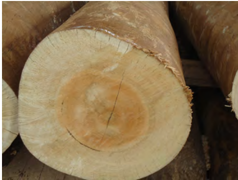
Figura 1. Madeira de eucalipto mais desejável para tratamento devido ao cerne de menor diâmetro e albúrneo mais espesso.
