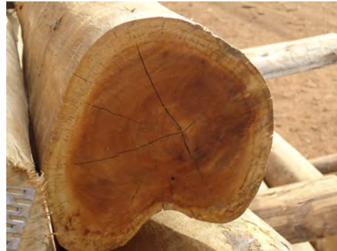
Figura 2. Madeira de eucalipto menos desejável para tratamento devido ao maior diâmetro do cerne e albúrneo mais fino.
