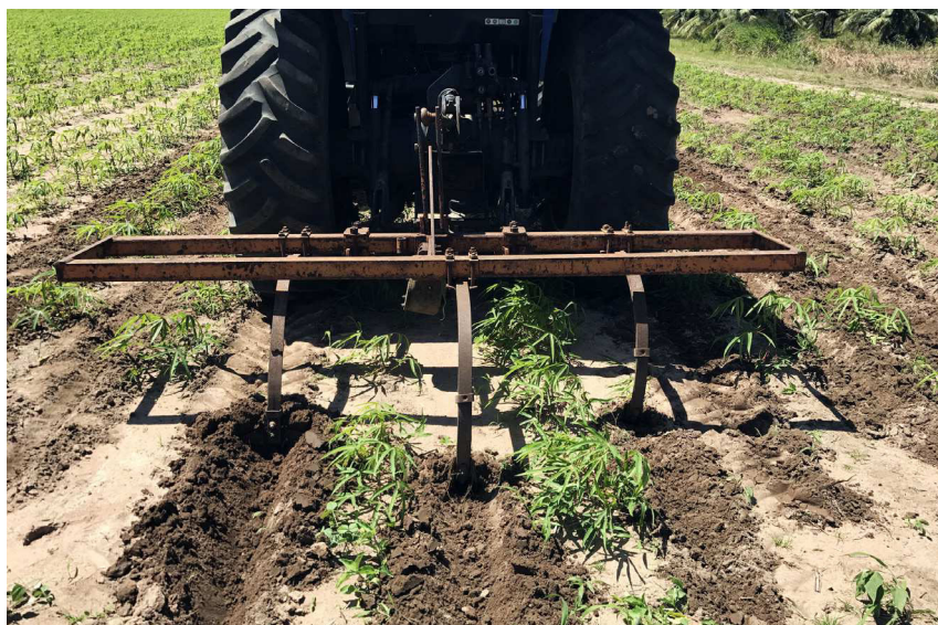
Figura 3. Cultivador adaptado ao trator efetuando controle de plantas daninhas em Tracuateua, PA, 2016.
