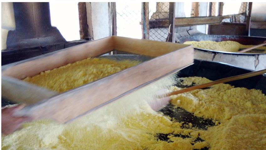
**Figura 3.** Peneira sobre o forno de torragem, para classificação da farinha e retirada dos grãos de farinha demasiadamente grossos.
