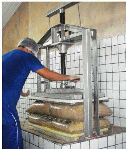
Figura 5. Prensa manual com rosca sem fim.
