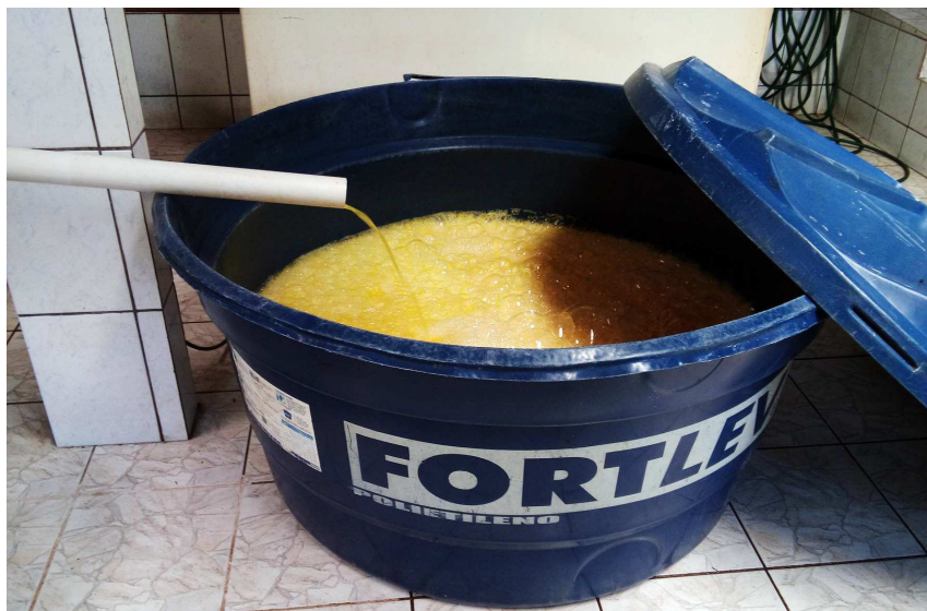
Figura 7. Fermentação da manipueira em tanques de polietileno.
