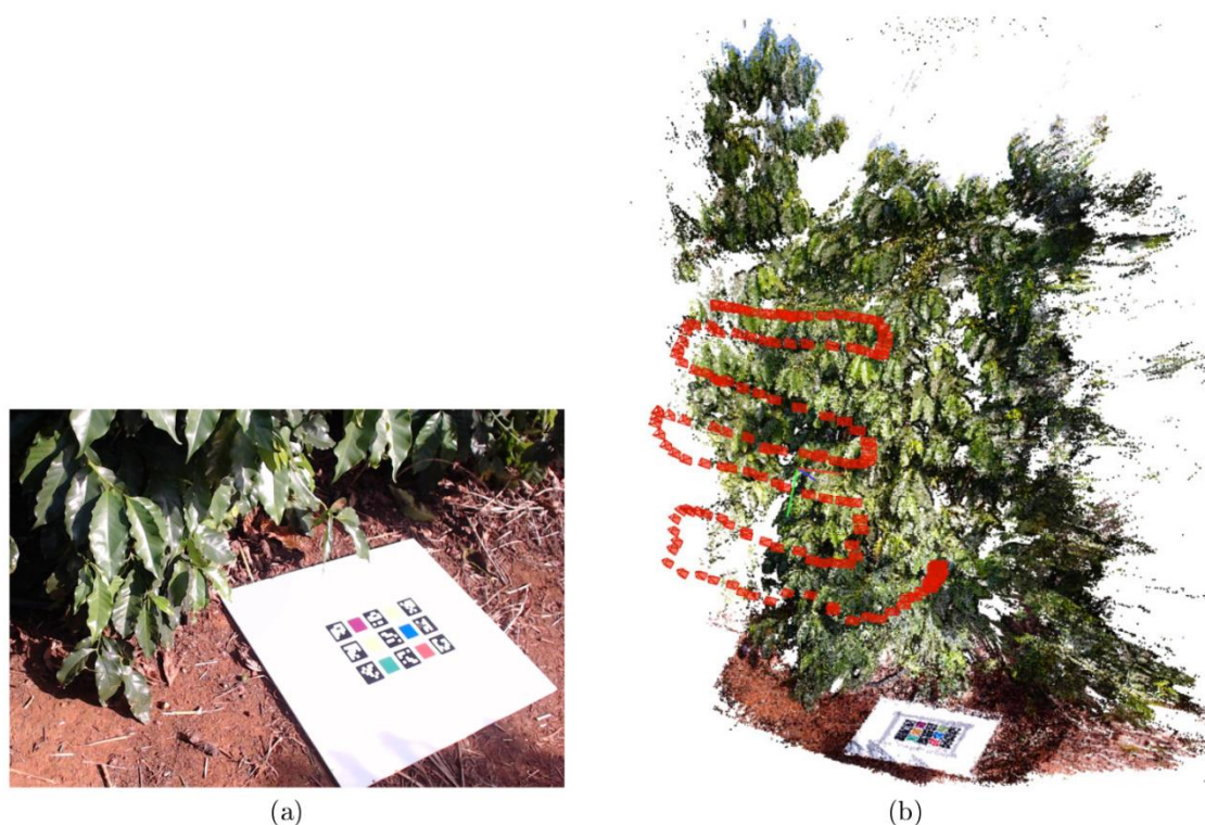
Figura 1. (a) Padrão de escala utilizado em cafeeiros. (b) Exemplo de aquisição - a posição e a orientação da câmera em cada uma das 167 imagens utilizadas neste modelo são indicadas pelas pirâmides vermelhas. Este modelo 3-D foi composto por 5.081.529 pontos.
