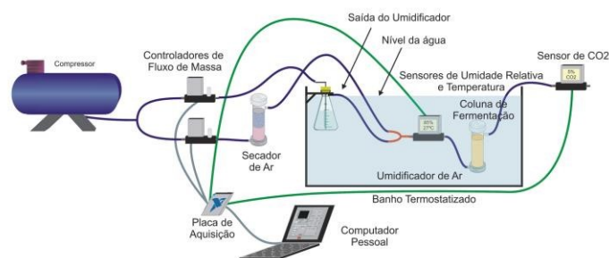
Figura 1. Representação esquemática do Reator de FES em colunas aeradas.
