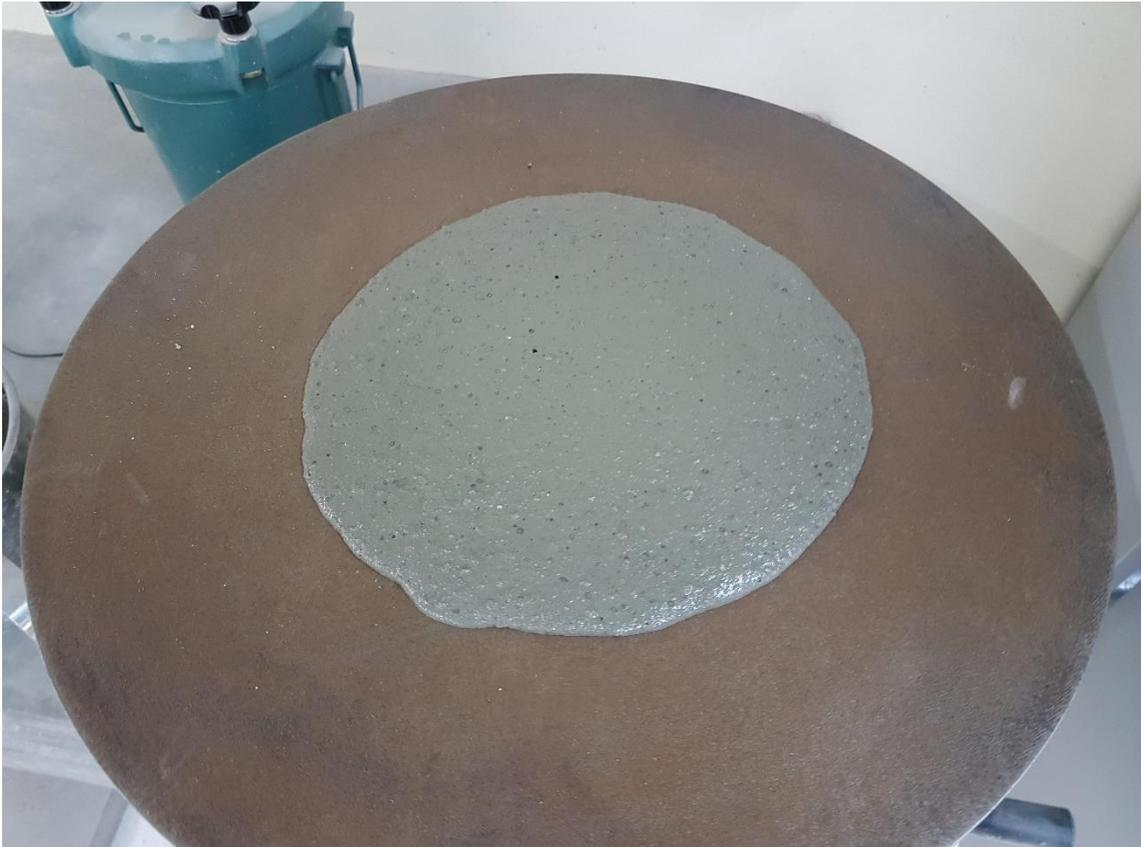
Figura 1. Traço com adição de Sílica Ativa e Nanossílica.
