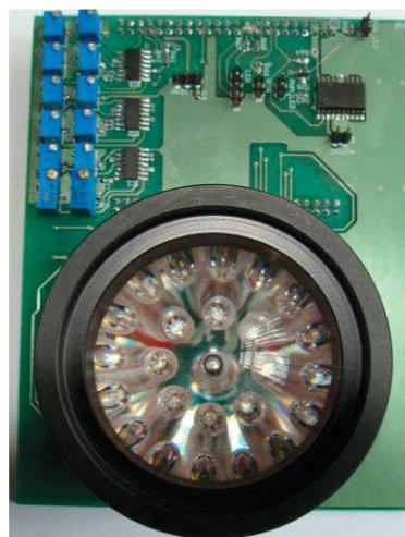
Figura 3. Vista interna da câmara de medição e do recipiente de entrada de amostra.
