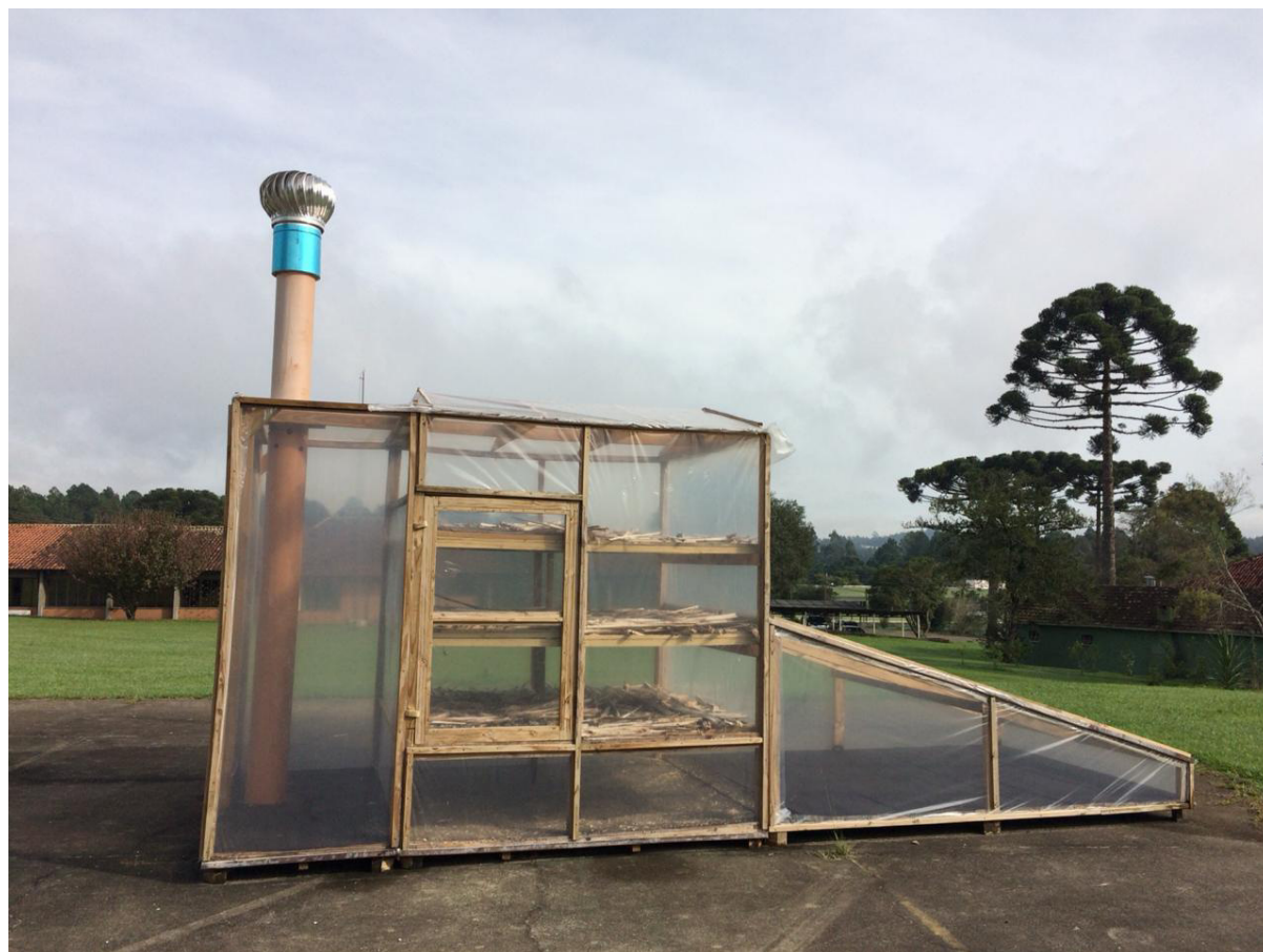
Figura 1. Secador solar utilizado no experimento.
