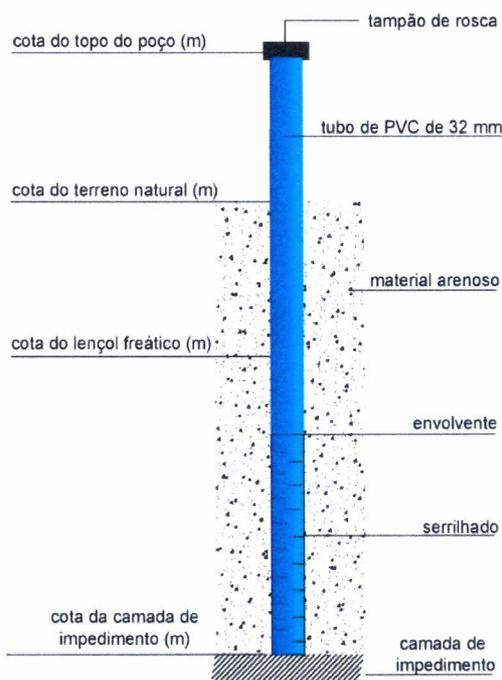
Figura 8. Instalação e referenciamento do poço de observação
