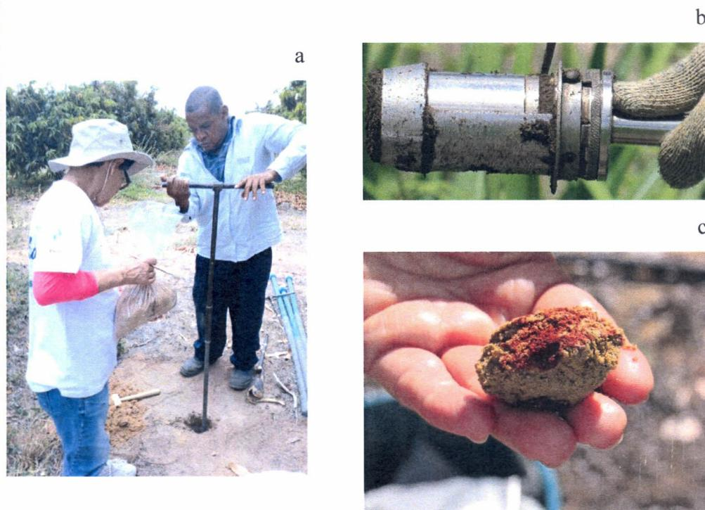
Figura 7. Procedimentos no campo para instalação dos poços de observação (PO) e amostragem de solo. a) tradagem para instalação dos poços b) coleta de amostras não deformadas c) identificação da presença de mosqueado.
