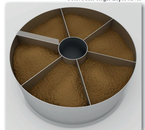
Figura 13.2. Exemplo de um recipiente-teste com seis seções.
