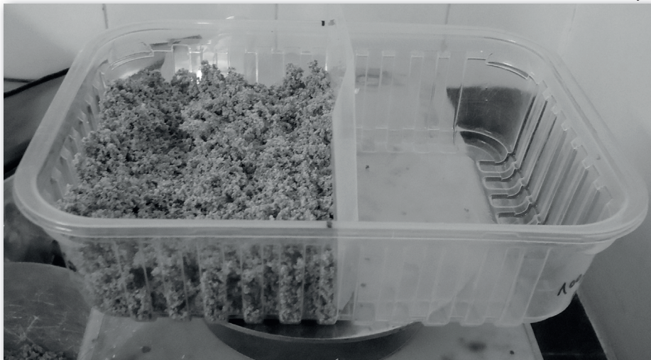
Figura 13.1. Exemplo de recipiente-teste em plástico, câmara com duas seções. A divisória está inserida durante a pesagem de cada uma das porções de solo. Após a pesagem, a divisória é retirada e as minhocas são adicionadas ao centro da caixa.
