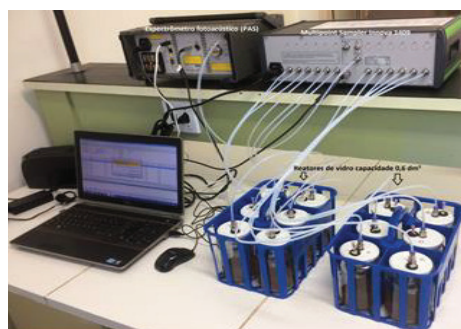
Figura 1. Equipamentos e reatores utilizados no experimento para medir a volatilização de amônia em solos fertilizados com ureia.
