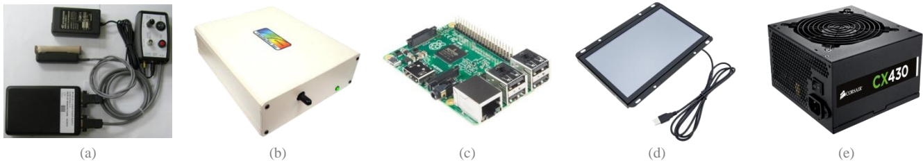
Figura 2. Equipamentos utilizados no sistema: laser (a), espectrômetro (b), computador (c), monitor (d) e fonte (e)
