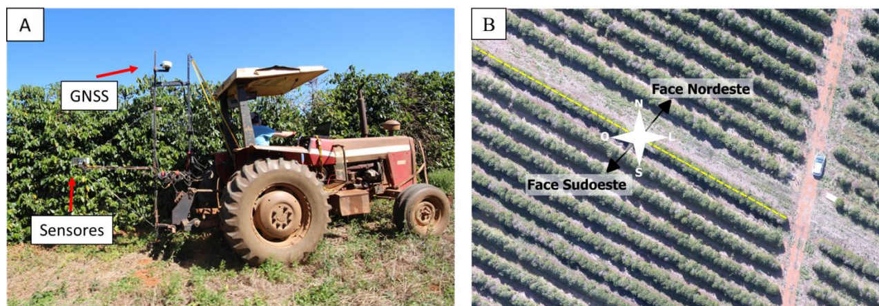
Figura 1. A) Sensores montados no trator, B) Sentido de posição das plantas de acordo com a sua face.
