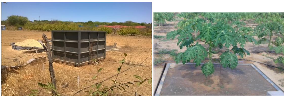
Figura 2. Lisímetro de pesagem utilizado para avaliação. Juazeiro –BA 2017.
