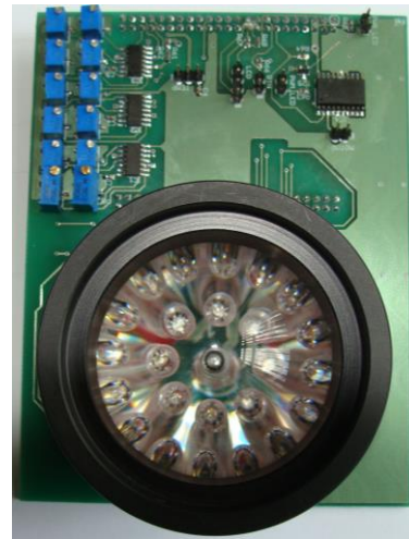
Figura 4. Detalhe da cabeça óptica e a placa de circuito eletrônico para acionamento dos LEDs.
