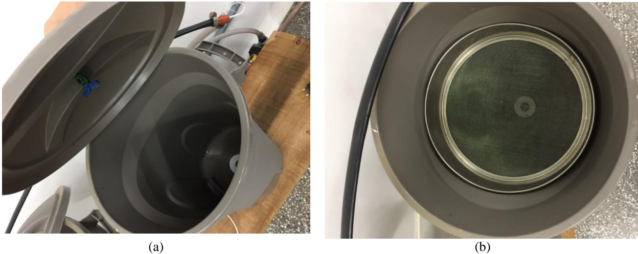
Figura 2 - Vista interna da Câmara de germinação, câmara de produção com microaspersor de água na tampa (a) e peneira de aço inox Brinox ® (18 mesh) (b).
