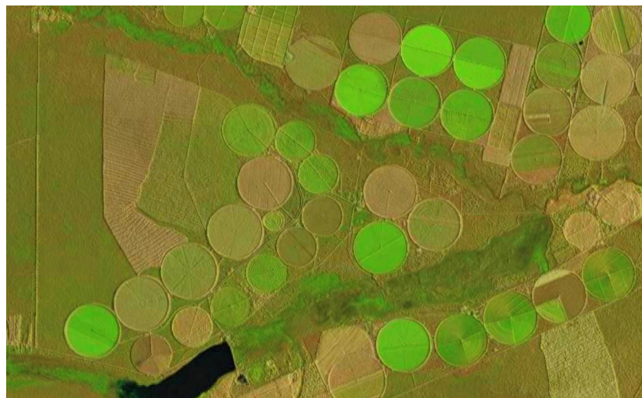
Figura 8. Uso de realce de contornos para identificação de pivôs centrais em imagens de satélite Landsat 8
