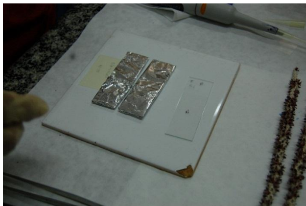
Figura 3 - Preparo de lâminas com pólen de Euterpe oleracea para teste colorimétrico com a solução Tetrazólio (0,1%).
