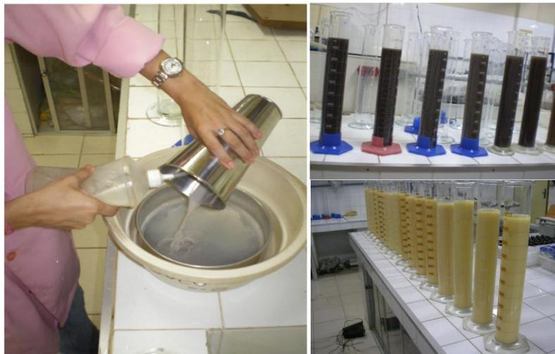
Figura 11. Procedimento para determinação da granulometria do solo pelo método da pipeta e tamisação.
