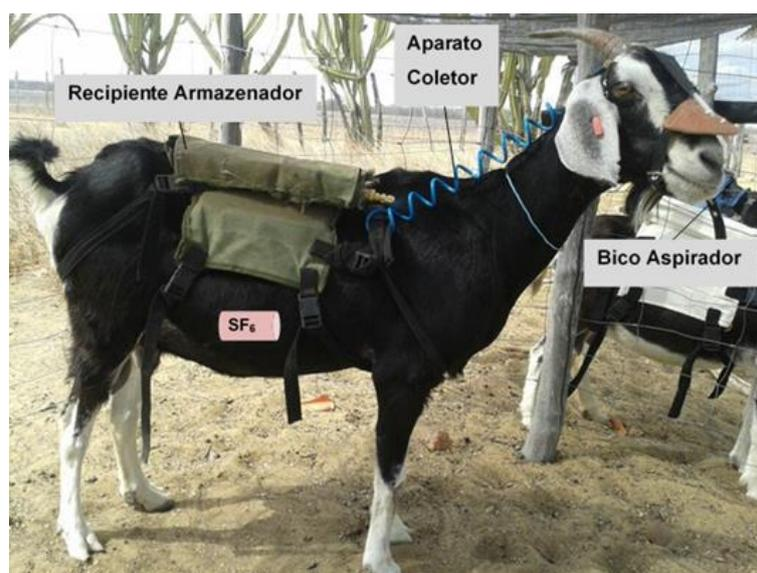
83 Figura 1. Sistema de amostragem e armazenamento de CH<sub>4</sub> entérico montado em um
