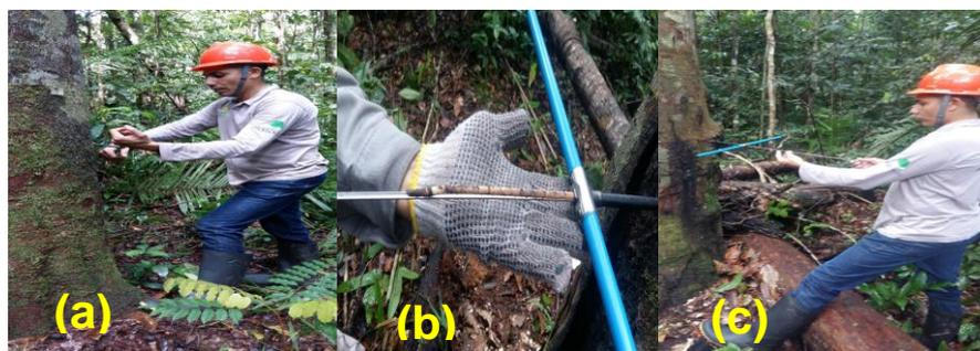
**Figura 6** - (a) coleta da amostra do lenho a 1 m de altura do tronco; (b) seção transversal do tronco e indicação do alinhamento de extração das amostras do lenho; (c) amostra do lenho retirada pela sonda de Pressler. Fonte: Acervo pessoal. Fonte: acervo pessoal.
