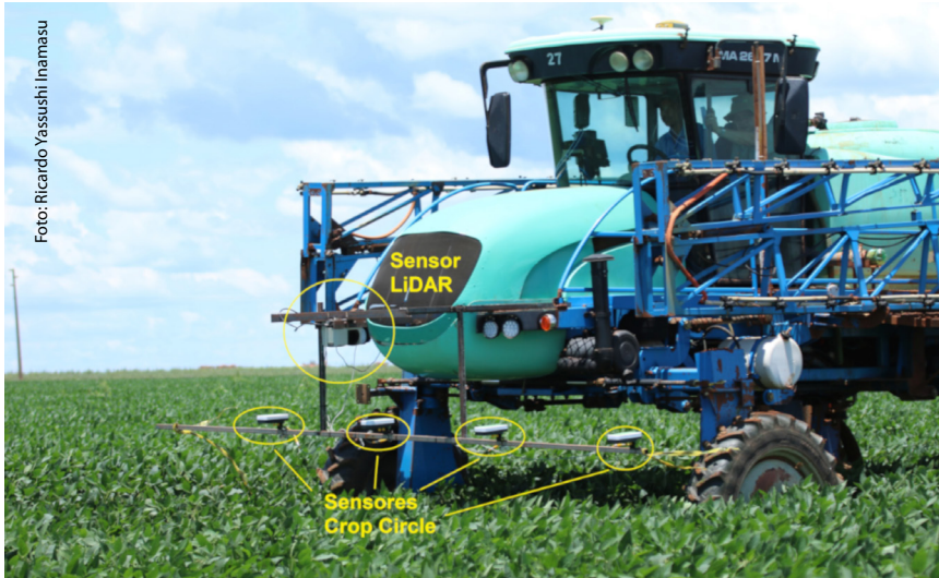
Figura 7. Utilização de sensor LiDAR em conjunto com sensores de reflectância Crop Circle®, embarcados em implemento para detecção de altura de plantas.
