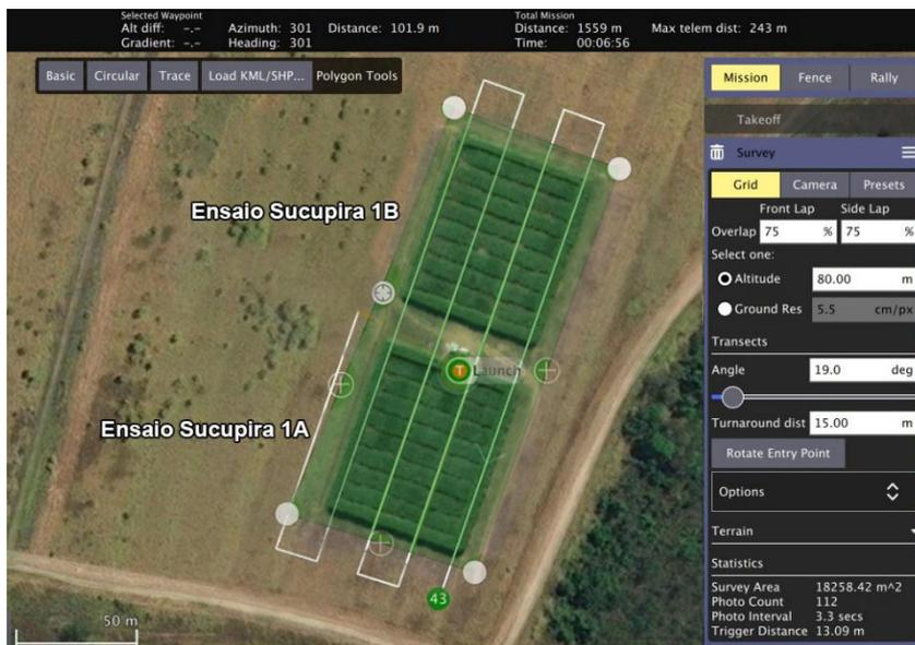
Figura 2. Plano de voo sobre a área experimental no software QGroundControl.
