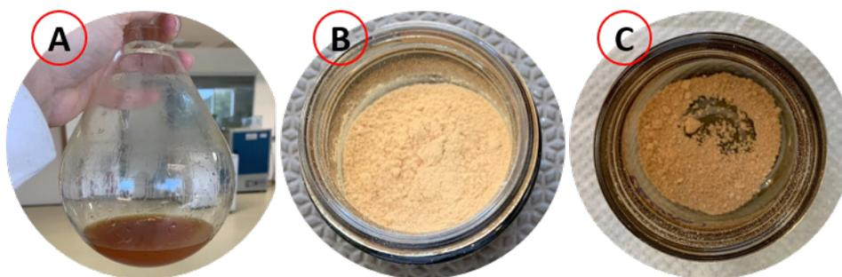
**Figura 1.** Extrato após evaporação parcial do etanol (A); Extrato obtido com adição de Aerosil 200® e secagem em *spray-dryer* (B); Extrato obtido com adição de goma arábica e secagem em *spray-dryer* (C).
