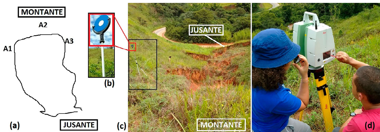
Figura 2 - (a) representação da posição dos pontos de varredura A1, A2 e A3; (b) no detalhe, alvo do LST; (c) alvo no ponto A3; (d) configuração de varredura do Leica Laser Scanner , definindo resolução, área e angulação para escaneamento. Fotos: Diego Suarez (2018).
