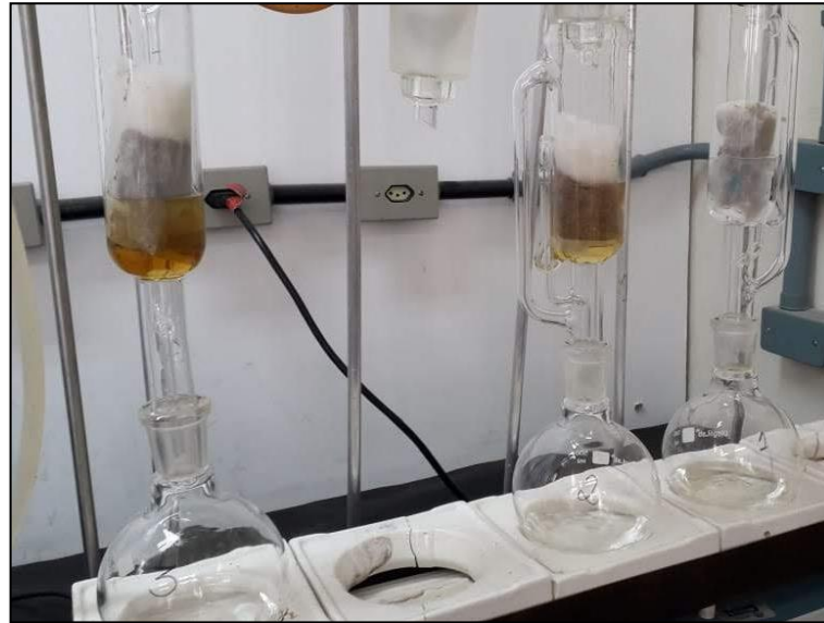
Figura 20. Determinação de extrativos em aparelhagem de extração por Soxhlet. Laboratório de propriedades da madeira, Universidade Federal de Pelotas, 2019. (Imagens: Nidria Dias Cruz)
