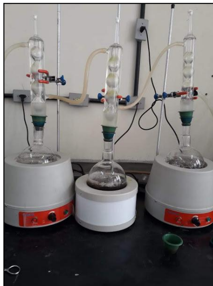
Figura 22. Determinação de celulose. Laboratório de propriedades da madeira, Universidade Federal de Pelotas, 2020. (Imagem: Nidria Dias Cruz)
