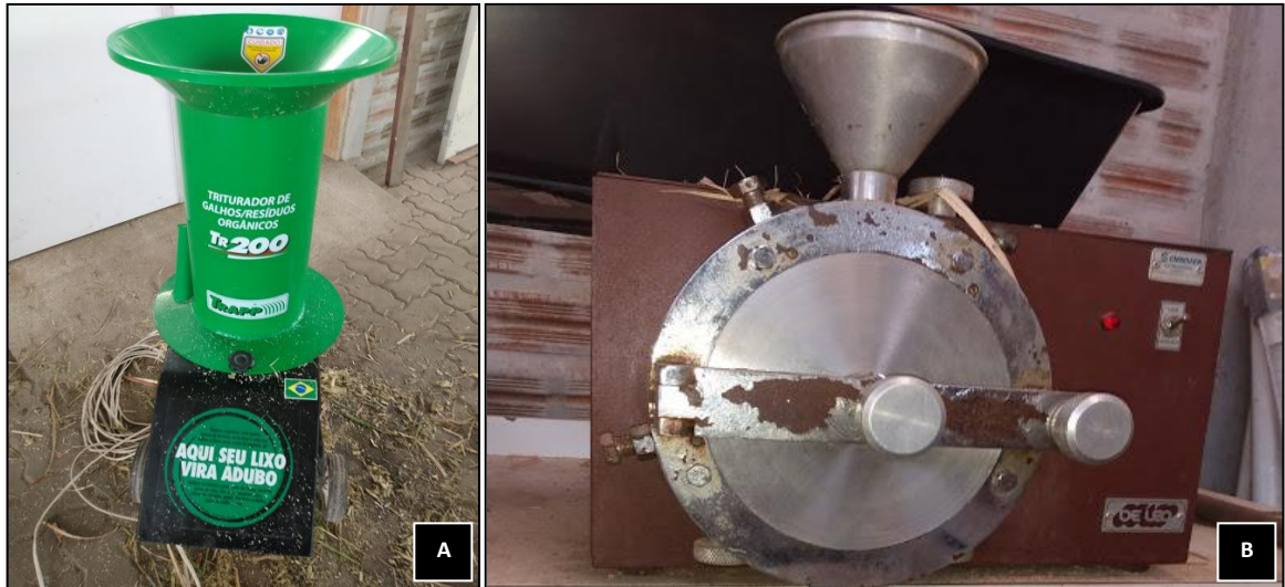
Figura 18. A) Triturador de galhos e resíduos orgânicos, modelo TR 200; B) moinho de facas. Embrapa Clima Temperado, Pelotas/RS, 2019. (Imagens: Ester Schiavon Matoso)
