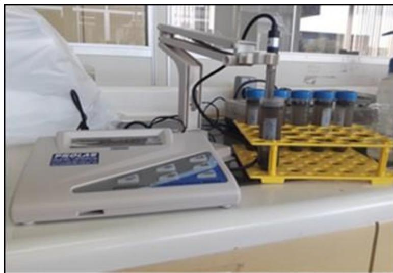
**Figura 5-** Determinação de pH e condutividade elétrica de compostos orgânicos e substratos.
