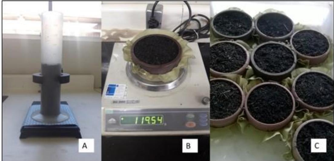
**Figura 7-** Amostra alocada no suporte para proveta a 10 cm de altura (A), pesagem da amostra em balança de precisão (B) e materiais postos a saturar imersos em água a 1/3 da altura do cilindro.
