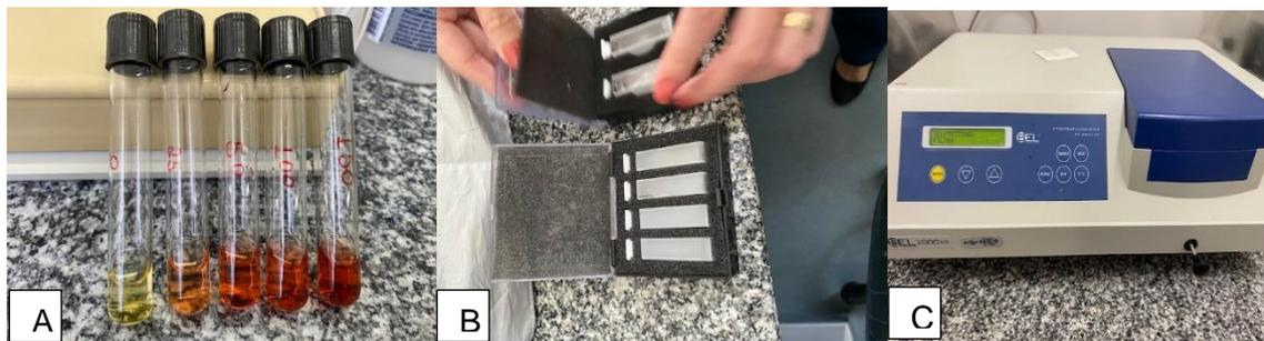
**Figura 3 - Na figura A é possível ver as cubetas onde foi feita as leitura do teste de produção de auxinas, na figura B está a curva-padrão para o teste e na figura C está a espectrofotômetro utilizado. Acervo próprio.**
