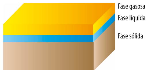
Figura 2. Representação esquemática do solo, segundo a composição de suas frações.
