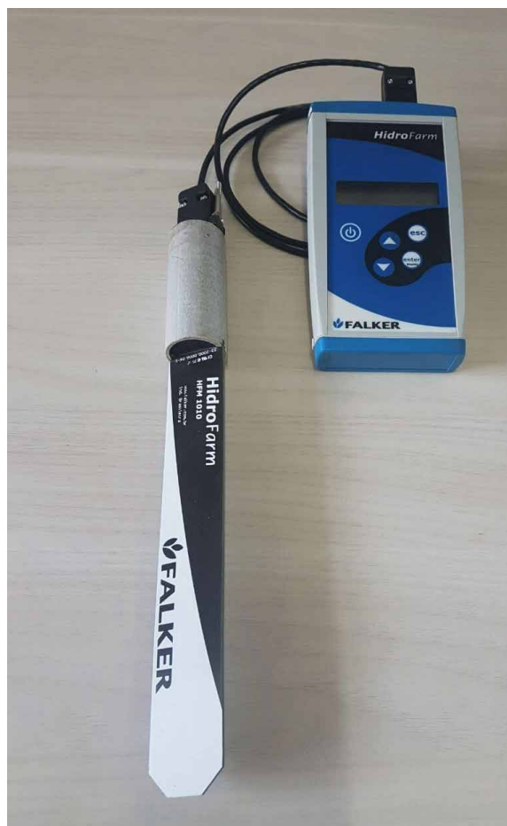
Figura 3. Medidor do teor de água do solo tipo Impedância do Solo em Alta Frequência (Isaf).
