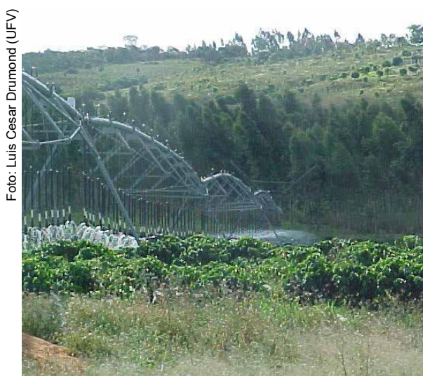
Figura 38. Pivô central dotado de low elevation spray application (Lesa) em café cultivado em topografia ondulada.
