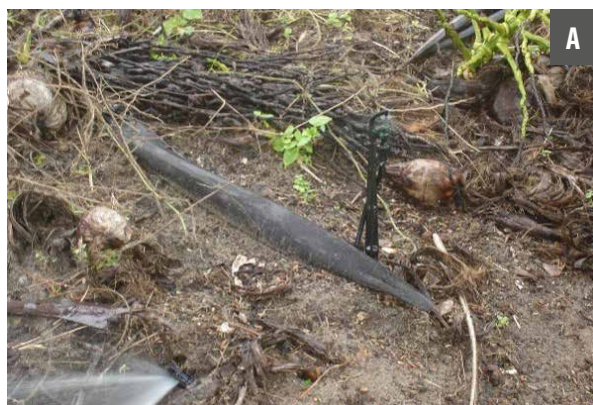
Figura 27. Lateral danificada por capina (A) e bailarina de microaspersor paralizada por planta invasora (B).
