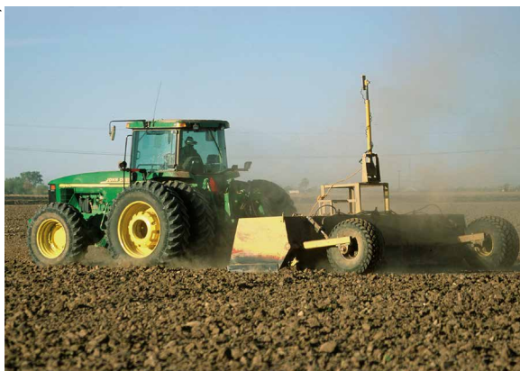
Figura 4. Sistematização de área empregando equipamento de nivelamento a laser.
