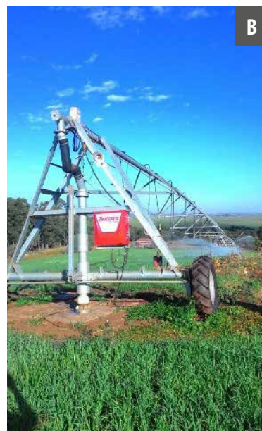
Figura 39. Pivôs centrais rebocáveis, indicando base dotada de quatro rodas (A) e de duas rodas (B) para mudança de área.
