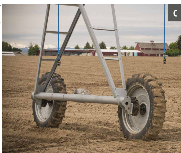
Figura 37. Lateral de um pivô central indicando a estrutura de sustentação em formato de “A” (A), base do pivô (B), motor com motorreductor de acionamento das rodas (C) e caixa com micro interruptor (D).
