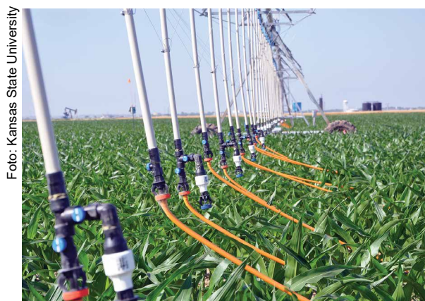
Figura 41. Pivô central tipo Lepa sendo testado em lavoura com detalhe das mangueiras com gotejadores.
