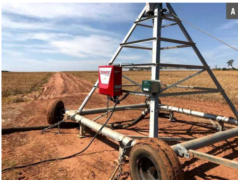
Figura 39. Pivôs centrais rebocáveis, indicando base dotada de quatro rodas (A) e de duas rodas (B) para mudança de área.
