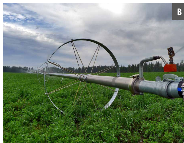
Figura 35. Ramal rolante (rolão) irrigando trigo (A) e detalhe do aspersor escamoteável (B).
