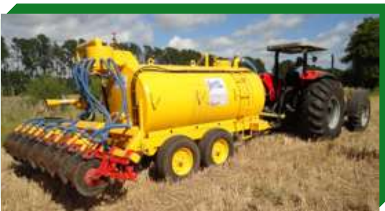
Figura: Equipamento desenvolvido para a injeção de dejetos líquidos de animais em subsuperfície no solo, em sistema de plantio direto
