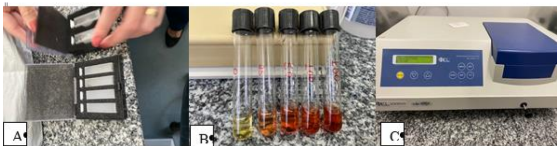
Figura 3 - A) cubetas utilizadas no teste de produção de auxinas; B) curva-padrão com ácido indolacético; C) espectrofotômetro utilizado.
