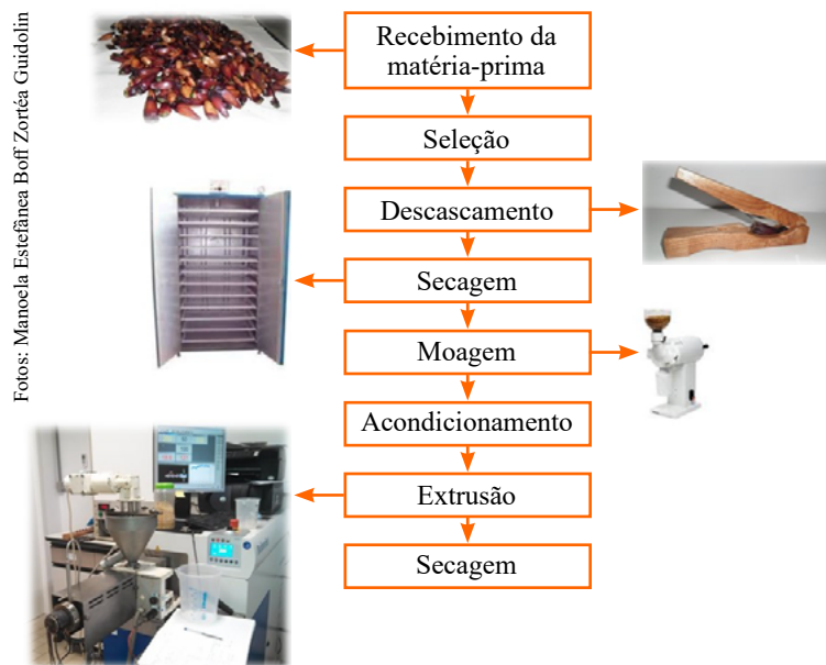
Figura 10. Diagrama de fluxo de produção de extrusados de pinhão.
