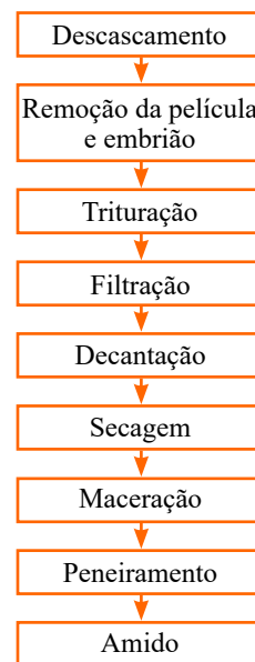
Figura 3. Fluxograma do processamento do amido de pinhão
