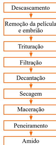
**Figura 3.** Fluxograma do processamento do amido de pinhão
