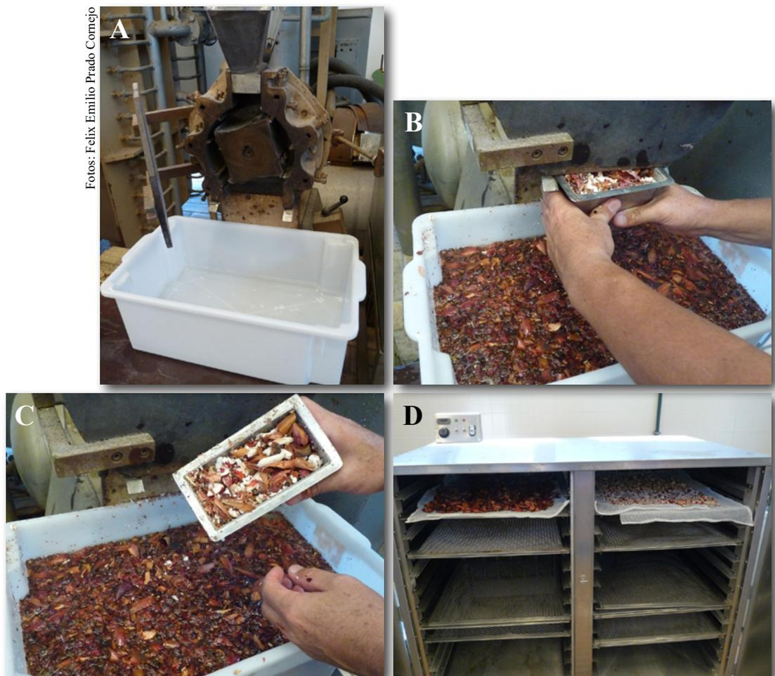
**Figura 2.** Descascamento mecânico do pinhão (A) moinho de facas; trituração do pinhão inteiro (B); material triturado na água (C); secagem das amêndoas e cascas (D).
