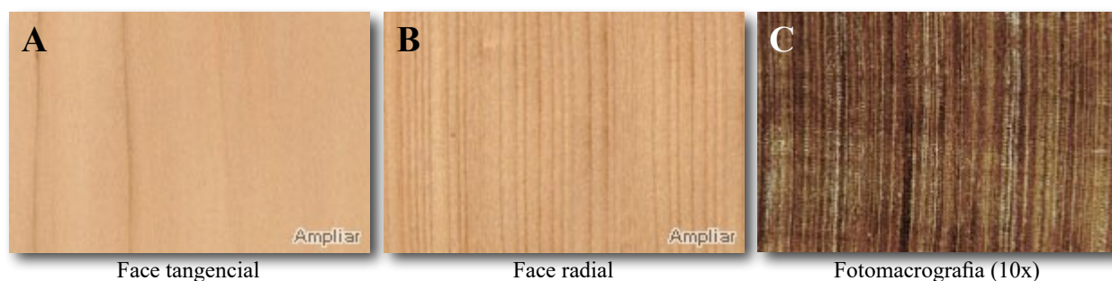
Figura 2. Aspecto das faces tangencial/radial (A e B) e fotomacrografia - 10x (C).
