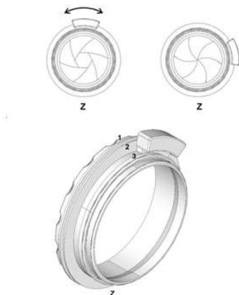
Figura 3 –Válvulas circulares laterais compostas por porca (1), rosca (2) e anel (3), Brasil, 2021
