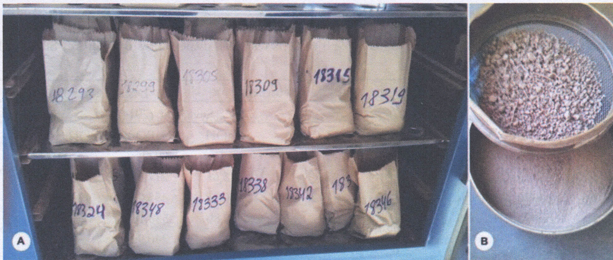
Figura 1. Amostras de terra em estufa de ventilação forçada a 40°C (A), destorroamento e peneiramento (B). Fonte: Maria Alcirlândia da Silva Bezerra.
