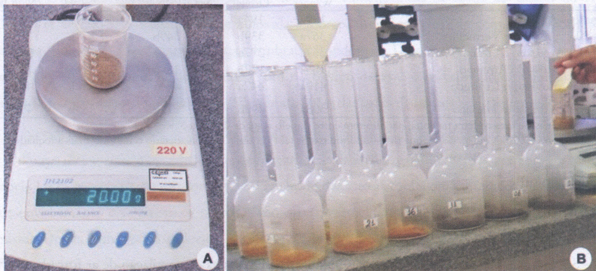
Figura 2. Pesagem 20 g de TFSA (A); Amostra em recipientes do agitador tipo Wagner (B). Fonte: Maria Alcirlândia da Silva Bezerra.
