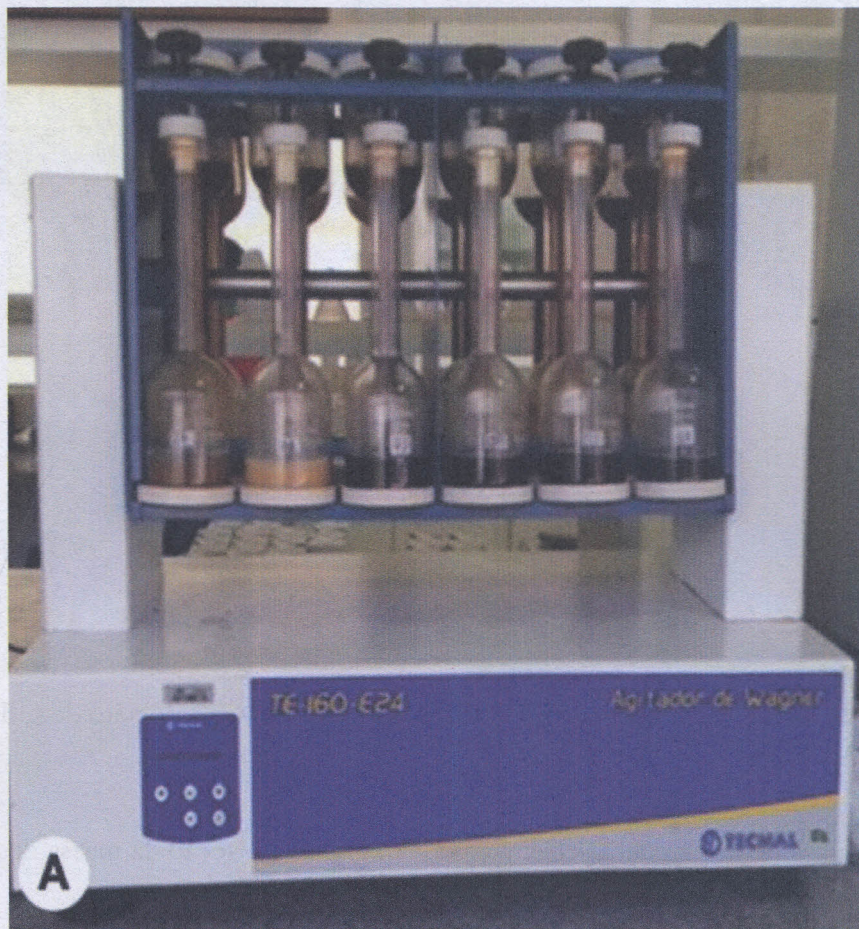
Figura 4. Amostras em agitador de Wagner. Fonte: Maria Alcirlândia da Silva Bezerra.
