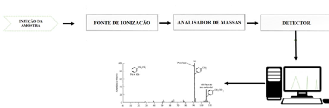
Figura 6 – Componentes de um espectrômetro de massas
