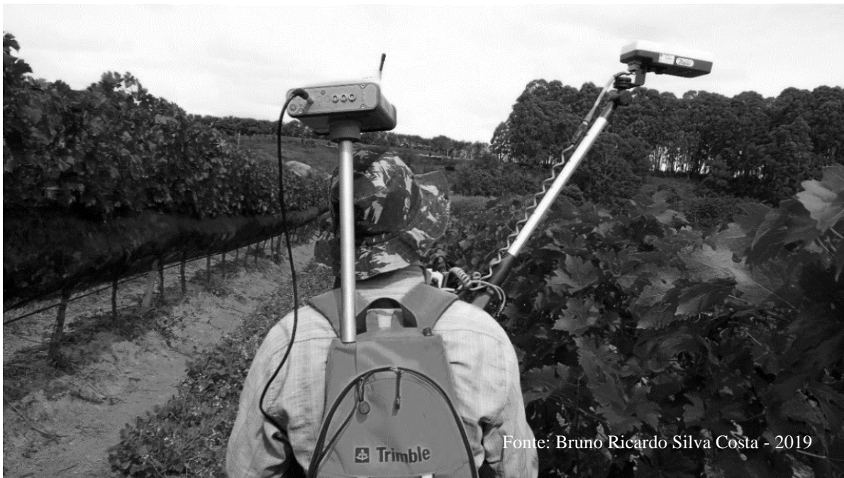
Figura 4 - Amostragem de dados georreferenciados da reflectância do dossel das videiras utilizando-se o sensor ativo ACS-430
