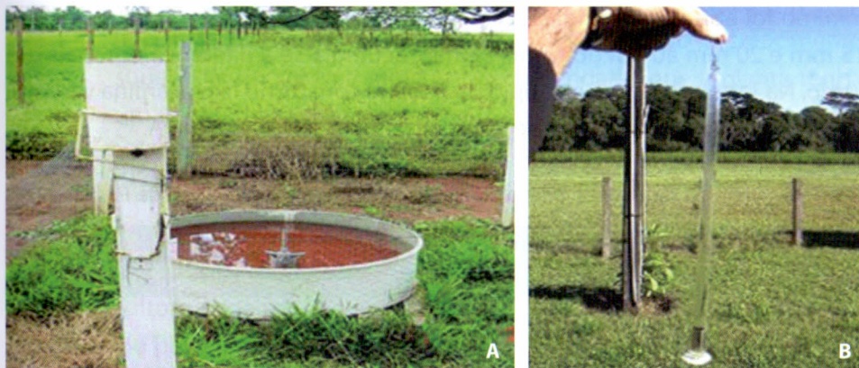
Figura 1. Tanque Classe A e pluviômetro, utilizados no manejo de irrigação – método EPS (A); evaporímetro de Piché, que pode ser utilizado em substituição ao tanque do tipo Classe A (B).
