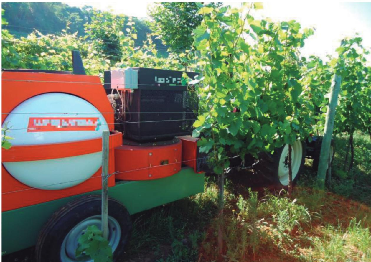
**Figura 2.** Implemento de ventilação de ar quente (fluxo de ar quente, FAQ) associado à tecnologia Thermal Pest Control (TPC) sendo puxado por trator.
