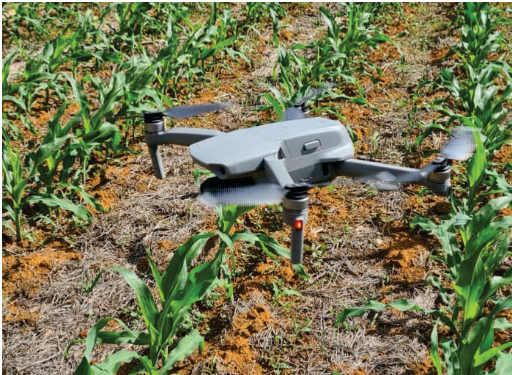
Figura 9. Drone com dispositivo para aplicar Trichogramma em milho.
