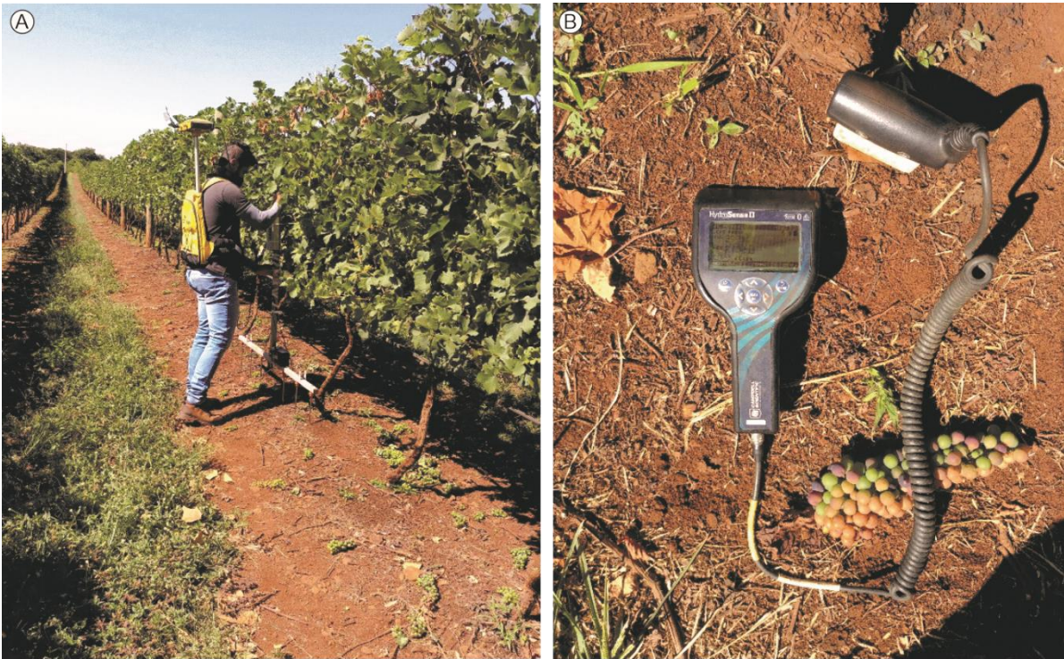
Figura 11 – A: Medições da condutividade elétrica aparente do solo; B: leituras de umidade volumétrica do solo
