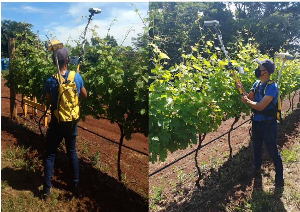
Figura 10 – Captura dos dados de refletância de forma vertical do dossel pelo Sensor Crop Circle ACS-430
