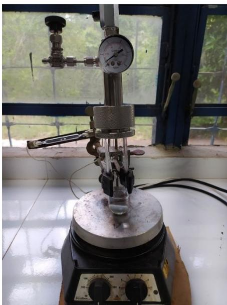
**Figura 32:** Imagem do sistema catalítico de redução do nitrobenzeno.
