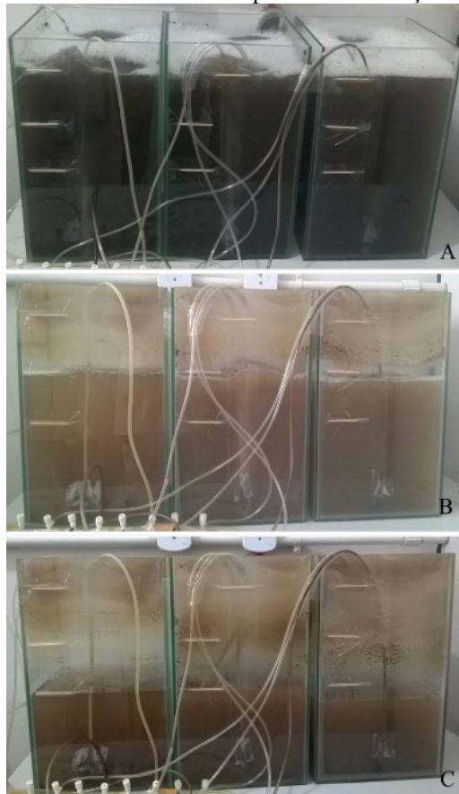
Figura 4: Redução do volume e alteração da cor da água residuária da suinocultura durante a digestão aeróbia. No início do processo de digestão aeróbia, o efluente apresentava coloração preta (A), após os 12 dias (B) e 23 dias (C) de tratamento o efluente apresentou coloração mais clara.
