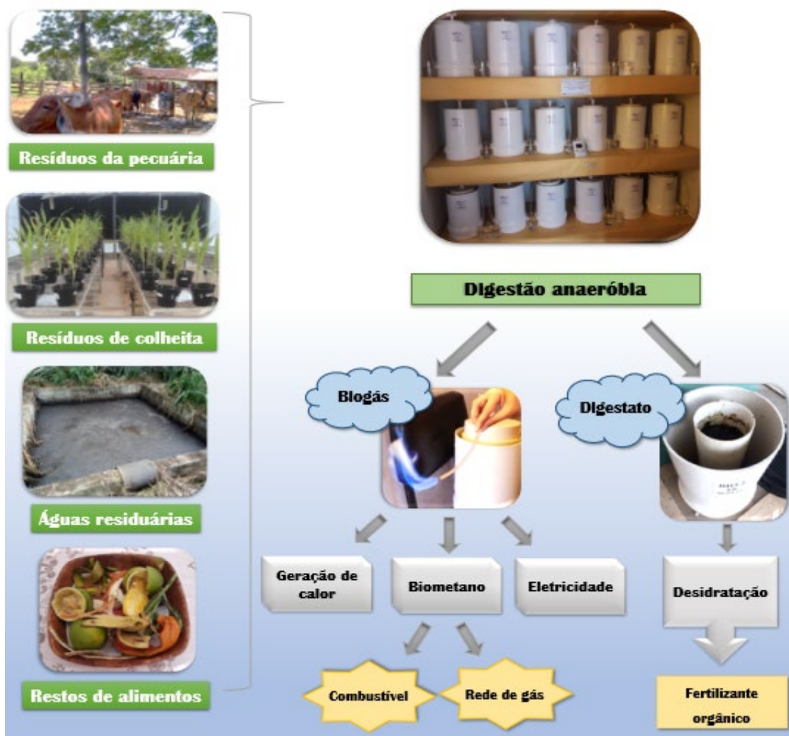
Figura 1: Detalhamento da biomassa vegetal e animal que pode ser utilizada no processo de biodigestão anaeróbia e, seus respectivos produtos.
