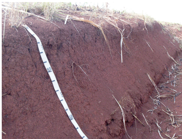
Figura 12.7: Perfil de Nitossolo Vermelho (NV) representativo da Região Metropolitana do Recife. Fonte: acervo dos autores.
