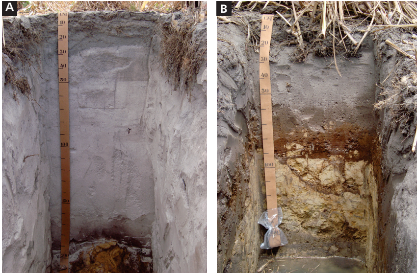
Figura 12.3: Espodossolos representativo da Região Metropolitana do Recife. A) Espodossolo Humilúvico Órtico espessarêncico (EKo1) em função da textura arenosa até o B espódico entre 100 e 200 cm; B) Espodossolo Humilúvico Órtico dúrcico (EKo2) em função da cimentação forte dentro de 150 cm. Fonte: acervo dos autores.
