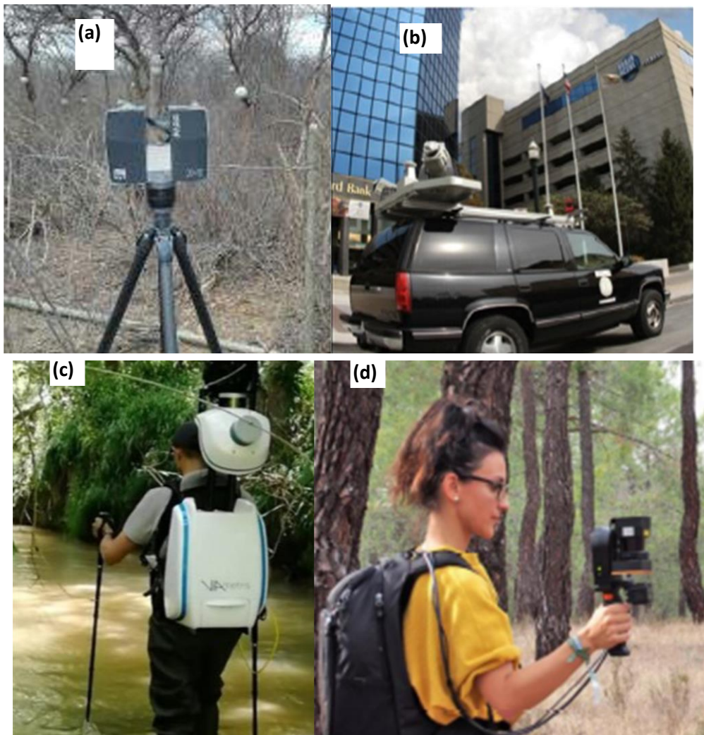
Figura 3. Tipos de suporte de varredura a laser terrestre: (a) tripé; (b) em veículo motorizado; (c) em mochila; (d) de mão. Fonte: (a) Adriana A. M. Nishiwaki (2022); (b) Aijazi et al. (2017); (c) Viametris.com; (d) Cabo et al. (2018).
