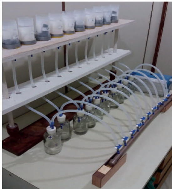
Figura 6. Sistema de extração a vácuo e filtragem usado para avaliação da liberação de nitrogênio a partir de fertilizantes nitrogenados.
