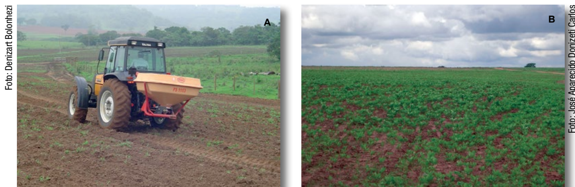
Figura 6. Distribuidor pendular de sementes (A); campo de Crotalaria spectabilis semeada a lanço, em Catanduva, SP (B).
