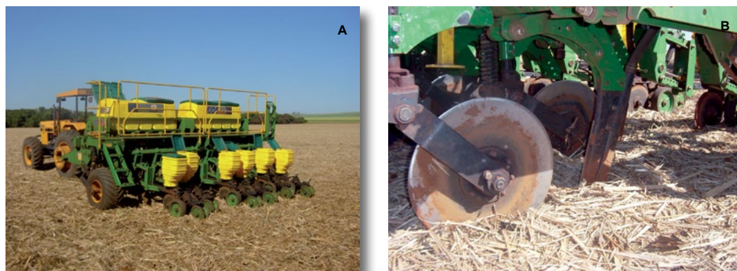
Figura 10. Semeadora específica para semeadura direta em cultivo intercalar de soqueira de cana crua (A); detalhe do disco corta-palha e “facão” (B).
