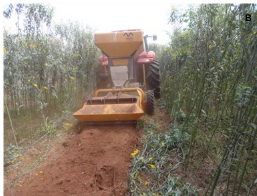
Figura 22. Equipamento utilizado para preparo localizado e incorporação da fitomassa de Crotalaria sp. (A) e modelo com reservatório para aplicação de corretivos em profundidade (B).
