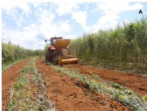
Figura 22. Equipamento utilizado para preparo localizado e incorporação da fitomassa de Crotalaria sp. (A) e modelo com reservatório para aplicação de corretivos em profundidade (B).
