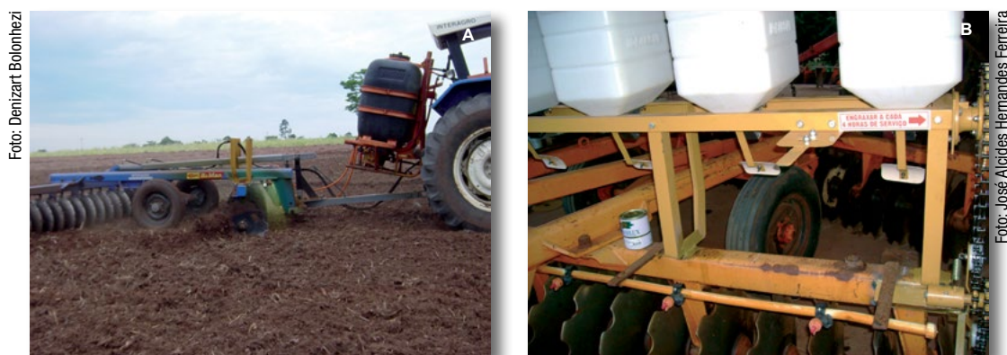
Figura 7. Sistema tríplice (semeadura, aplicação de herbicida e incorporação) de semeadura de crotalaria-júncea, em Catanduva, SP (A); vista com detalhe do equipamento (B).
