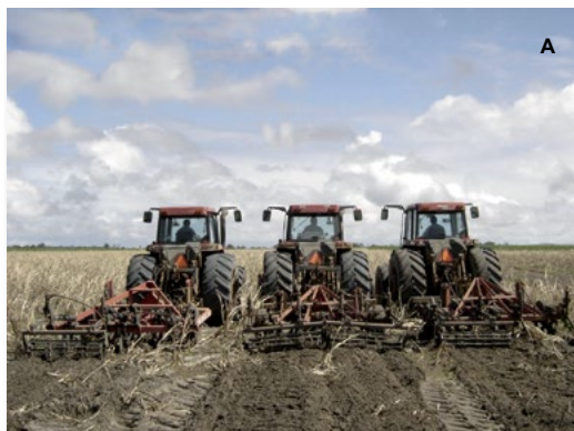
Figura 8. Subsolador com rolo destorroador, em Coruripe, AL (A); equipamento semelhante utilizado para cultivo mínimo, em Guaíra, SP, no ano de 2008 (B).
