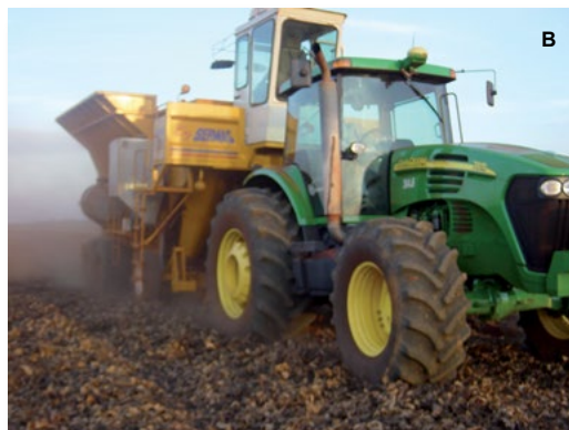
Figura 20. Plantadora semimecanizada sobre crotalária-júncea, em Campos dos Goytacazes, RJ (A); plantadora de cana picada sobre mucuna-verde, em Guairá, SP (B).
