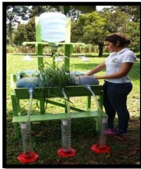
Figura 1- Simulador de erosividade.
