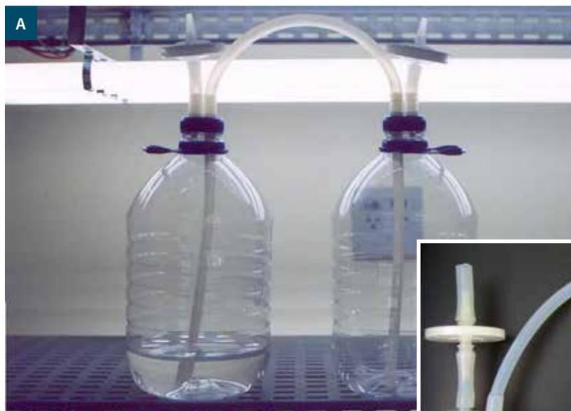
**Figura 31.** Unidade básica do biorreator de imersão temporária desenvolvido pela Embrapa: unidade básica do biorreator (A) e detalhe da disposição das mangueiras (B) para funcionamento como biorreator de imersão temporária.
