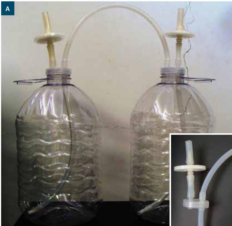
**Figura 33.** Disposição das mangueiras nos frascos para funcionamento do biorreator sob imersão permanente (A) e detalhe da conexão das mangueiras (B).
