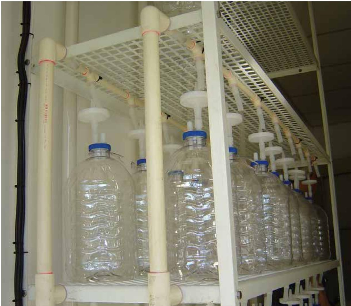
**Figura 26.** Tubulação lateral de PVC de 28 mm de diâmetro para conexão das prateleiras.
