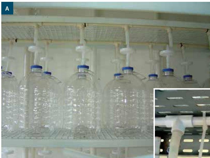
**Figura 25.** Tubulação horizontal de PVC de 15 mm de diâmetro externo para conexão com os frascos em cada prateleira: visão geral da linha dupla de canos da prateleira (A) e detalhe (B).
