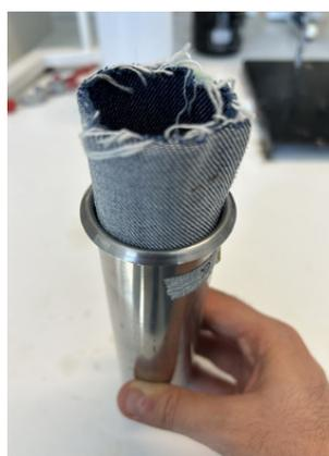
**Figura 1.** Formas de inserção do tecido denim às canecas: x) com o centro do tecido tocando o fundo da caneca e y) em formato cilíndrico, em contato com as paredes da caneca.
